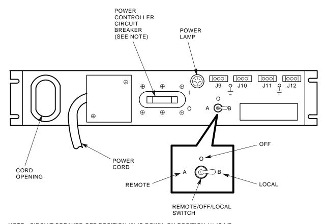
NOTE: CIRCUIT BREAKER OFF POSITION (0) IS DOWN, ON POSITION (1) IS UP.
