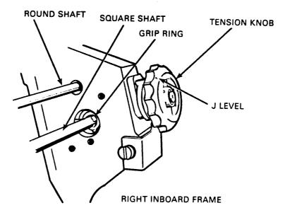
NOTE THE UPPER TRACTOR IS SHOWN. ON THE LOWER TRACTOR, THE SQUARE SHAFT IS ON THE TOP.
