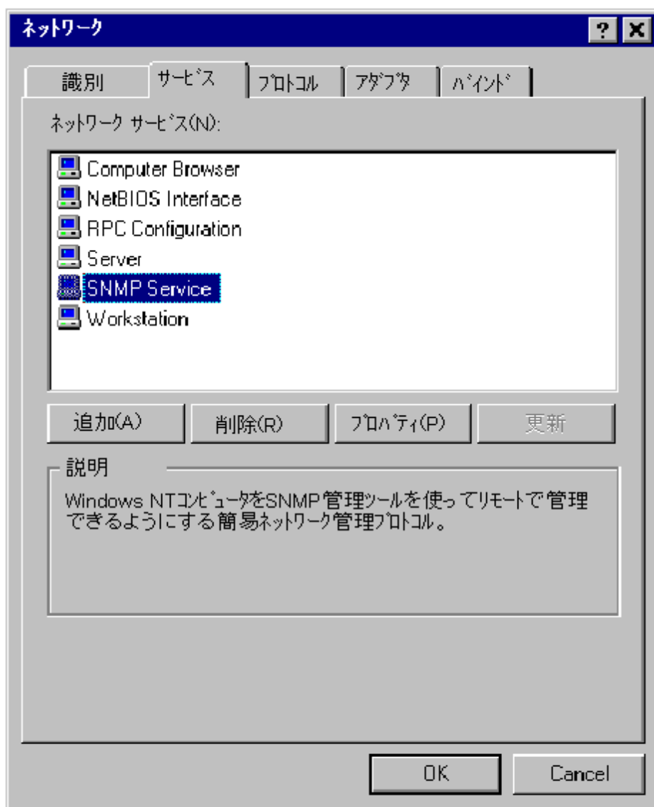
図 7-6 ネットワークサービスページからSNMPエージェントを選択する
