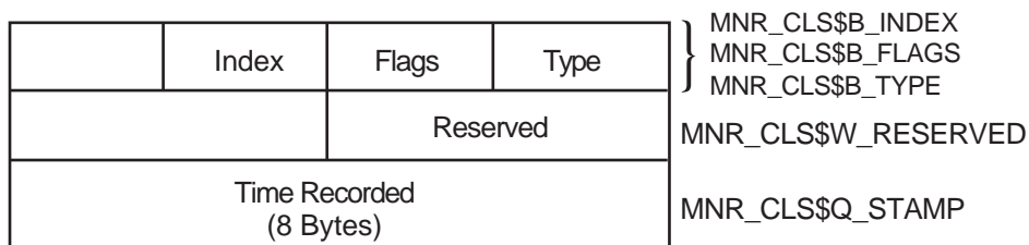
図 A-8 クラス・ヘッダの形式 - Alpha および I64
