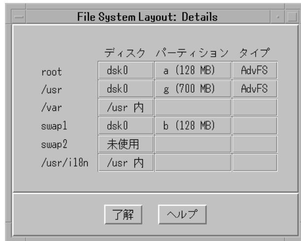
図 6-9: 「Default File System Layout: Details」ダイアログ・ボックス
