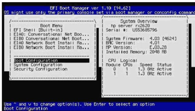
2. [Boot Configuration] メニューから [Console Configuration] メニューを選択し、**Enter** キーを押します。
