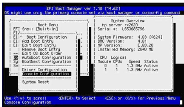
3. 希望するデバイスがすでにプライマリ・コンソールとして構成されていることが [Console Configuration] メニューに示されていれば、先に進む必要はありません。構成されていなければ、OpenVMS のプライマリ・コンソールにするデバイスを選択します。次の画面では、VGA デバイスを選択しています。
